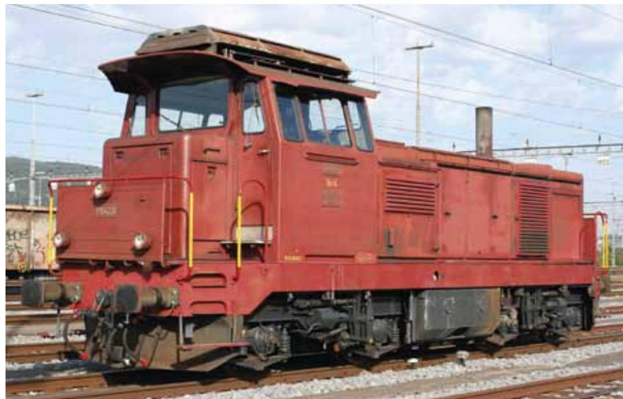
Diese Rückansicht der Bm 4/4 18423 entstand am 27. August 2007 im Rangierbahnhof Limmatal. Ausser dem Abgaskamin, den Hochleistungspuffern, dem Bühnengeländer und dem erst nachträglich montierten Magnet der Zugsicherung befindet sich die Lok äusserlich praktisch immer noch im Ablieferungszustand.
