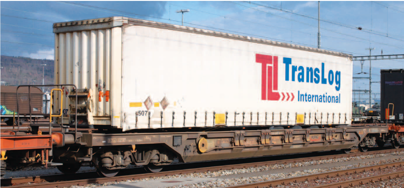
Mit ihren Drehgestellen der Bauart DRRS heben sich die T4 deutlich von den übrigen Taschenwagen ab. Der Sdgnss 33 85 450 6 141-2 2 war am 8. März 2012 in einen im Rangierbahnhof Limmattal abgestellten Zug eingereiht.
