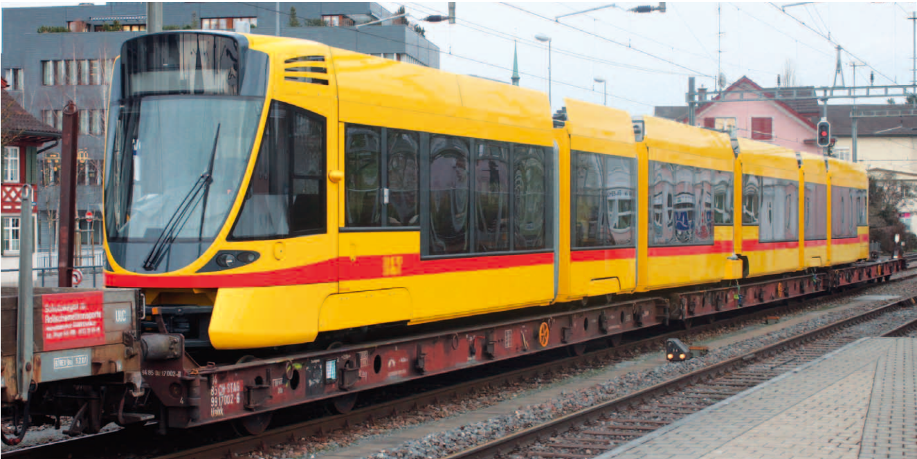
Am 5. März 2012 war am Schluss des Güterzuges 62880 Weinfelden–Rangierbahnhof Limmattal der auf die Uaikk 84 85 991 7 002-6, 000-0 und 001-8 verladene Be 6/10 161 für die Baselland Transport AG (BLT) angehängt. Das Bild entstand in Weinfelden. Nur die auf dem mittleren Rollschemel verladenen Elemente des Tango-Trams wurden mittels Radkeilen und Spannbändern gesichert, der vordere und der hintere Teil des Gelenktriebwagens auf den beiden anderen Rollschemeln konnten sich in Längsrichtung frei bewegen. Nur so konnte der aussergewöhnliche Transport ohne Schaden Kurven durchfahren.
