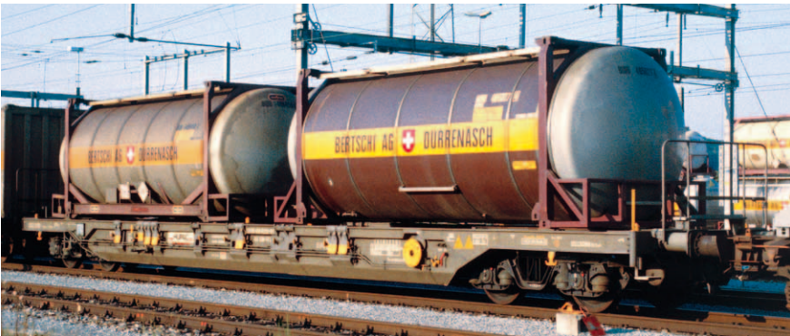
Mit ihren Drehgestellen der Bauart DRRS heben sich die T4 deutlich von den übrigen Taschenwagen ab. Der Sdgnss 33 85 450 6 141-2 2 war am 8. März 2012 in einen im Rangierbahnhof Limmattal abgestellten Zug eingereiht.
