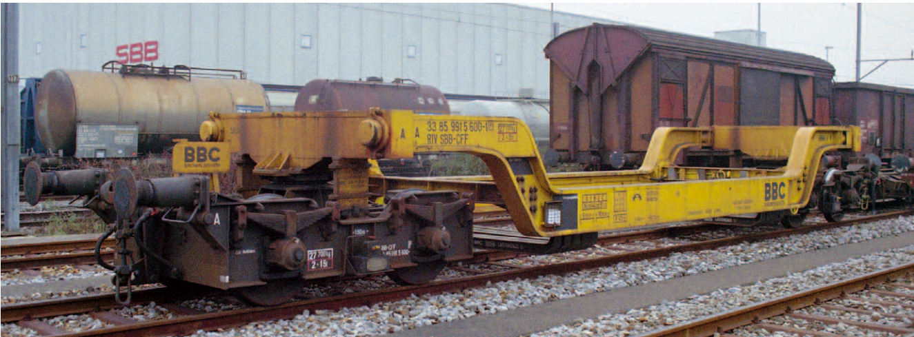
Der [Uai] 33 85 991 5 600-1 2 am 3. Dezember 1989 im Rangierbahnhof Limmattal. Gut erkennbar sind die in die Ladebrücke eingehängten Hilfsträger, welche je nach Bedarf beliebig verschoben oder auch entfernt werden konnten.
