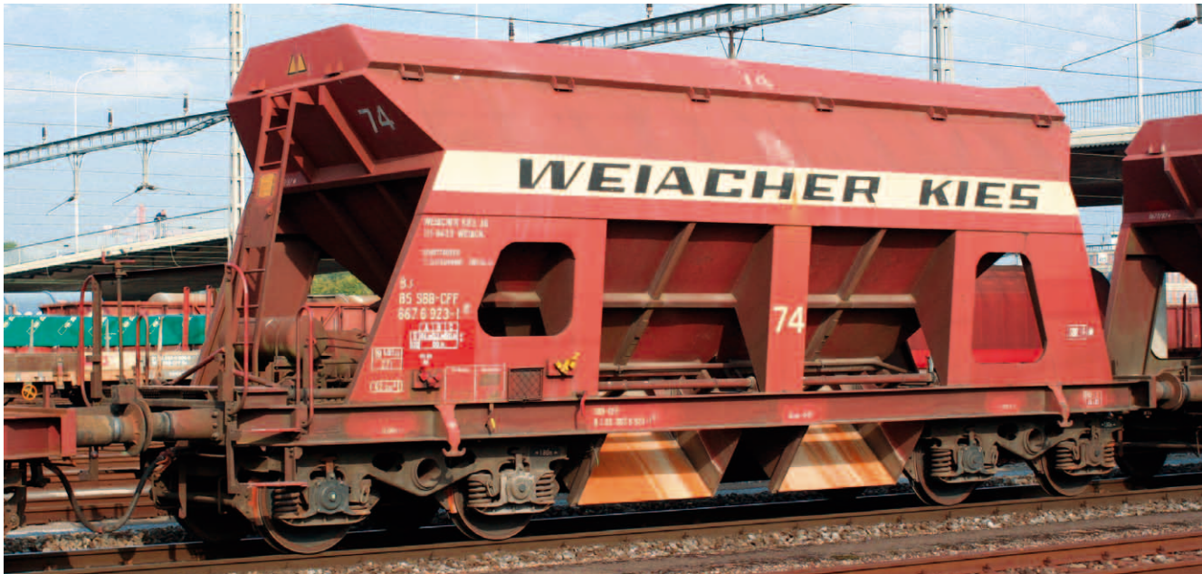
Der [Falls] 83 85 667 6 923-1 0 war am 7. September 2006 Bestandteil eines im Rangierbahnhof Limmattal abgestellten Blockzuges der Weiacher Kies AG. Der Lastgrenzraster war erst kurz zuvor auf 120 km/h angepasst worden.
