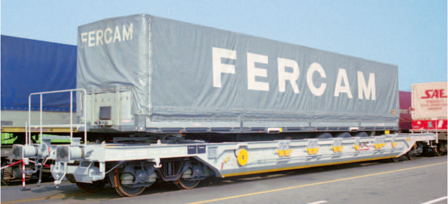
Anlässlich eines Presseinformationstages im Hupac-Terminal in Busto Arsizio (I) war am 18. Juni 1994 auch der fabrikneue T4 [Sdgnss] 33 85 451 1 045-8 2 ausgestellt. Unter dem vorderen Ende des Fercam-Sattelanhängers ist der Stützbock zu erkennen, welcher bei den T4 bei Nichtgebrauch in die Tasche heruntergeklappt wird.
