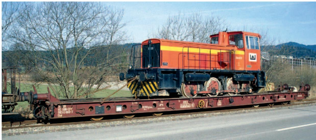
Eher ungewöhnlich ist, dass ein normalspuriges Fahrzeug auf einem Rollschemel überführt wird. Ob die niedrige Schleppgeschwindigkeit oder ein Schaden am Laufwerk der Grund war, dass diese 1972 von Cockerill gebaute Em 3/3 des Kieswerks Hüntwangen auf dem Uaai 31 85 993 0 000-7 transportiert werden musste, ist leider nicht bekannt. Die interessante Fuhre wurde am 18. Februar 1990 in Hinwil angetroffen.
