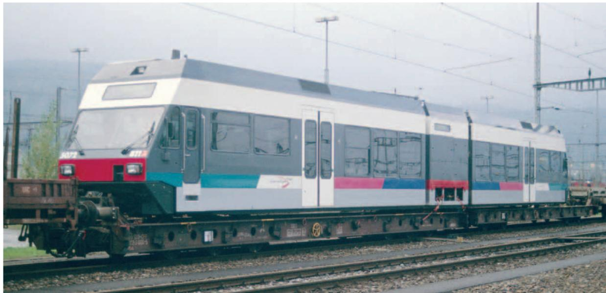
Für die Überführung des BTI-GTW Be 2/6 5072/5070/5071 von Bussnang nach Biel wurden zwei Rollschemel benötigt. Die Hauptlast ruhte auf dem Uaai 82 85 993 0 000-5, während der Uaikk 82 85 991 7 001-0 deutlich weniger Gewicht zu übernehmen hatte, wie der Höhenunterschied eindrücklich beweist! Rangierbahnhof Limmattal, 24. Oktober 2000.
