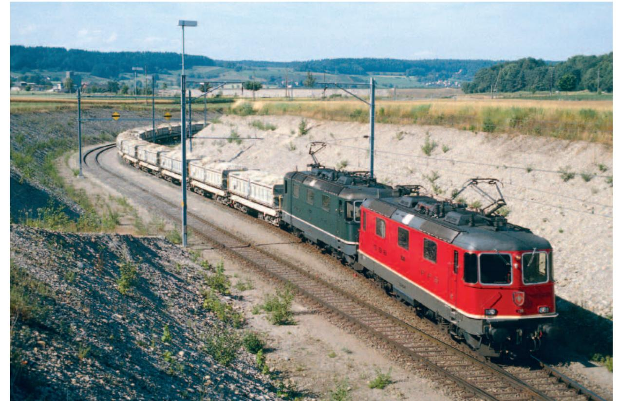
Die beiden Re 4/4<sup>II</sup> 11328 und 11347 haben soeben den aus Fans-u gebildeten Aushubzug 75048 Höcklerbrücke–Hüntwangen-Wil ins Anschlussgleis «Ghürst» des Kieswerks Hüntwangen zurückgestellt. Am anderen Zugsende wird demnächst die Diesellok des Kieswerks die Komposition übernehmen, um sie zum Entladegleis zu ziehen. Das Ausbruchsmaterial aus dem Tunnel Zürich–Thalwil wurde zu einem grossen Teil zum Verfüllen einer ausgebeuteten Kiesgrube verwendet. Aufnahmedatum ist der 1. Juli 2002.
