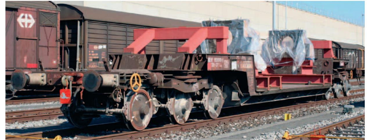
Am 31. August 2005 war der mit einem massiven Transportgestell für einen Rotor ausgerüstete Uaai 82 85 993 0 101-1 bei der Serviceanlage im Rangierbahnhof Limmattal abgestellt. Die Handräder der Feststellbremsen der beiden Drehgestelle sind gut zu erkennen.
