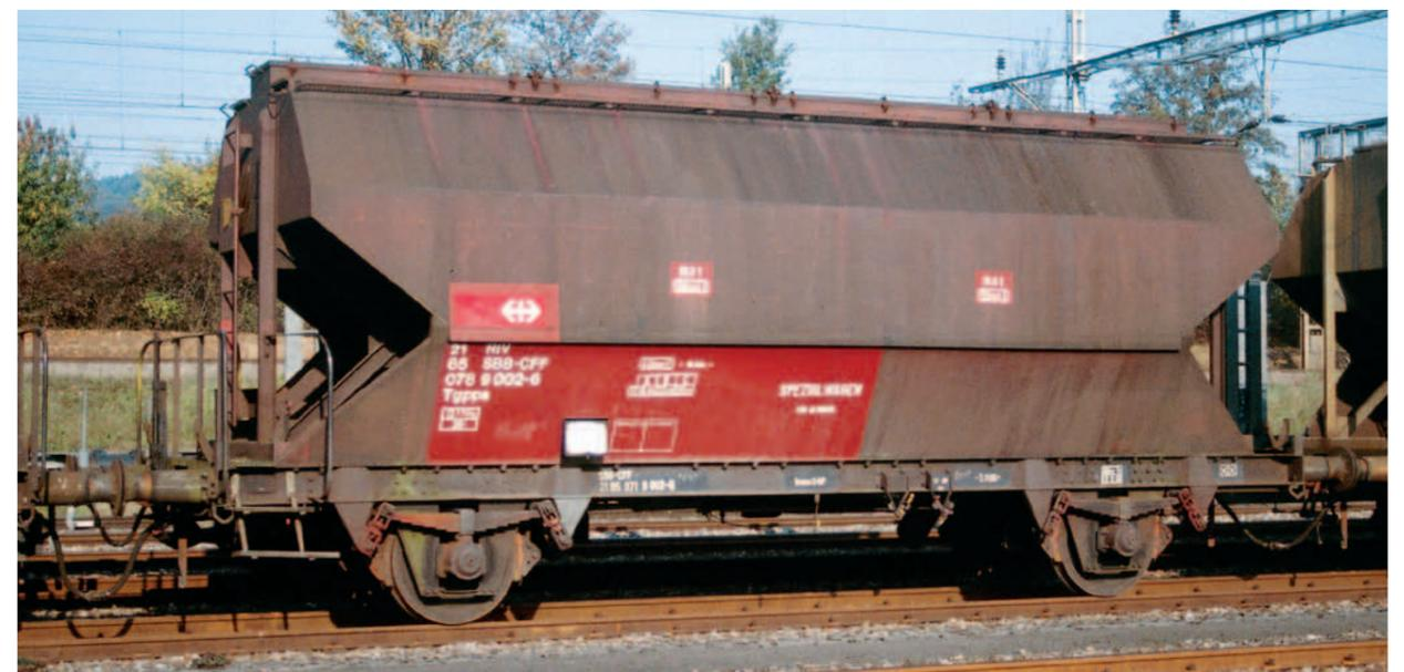
Am 22. Oktober 1995 war der Tgpps 21 85 078 9 002-6 im Rangierbahnhof Limmattal abgestellt. Das Laufwerk mit Doppelschaken-Federgehänge und den über den Federböcken befindlichen Kappen weicht wesentlich von den Serienwagen ab. Es entspricht hingegen demjenigen der zur selben Zeit beschafften gedeckten Güterwagen der Bauart K<sup>4</sup>.
