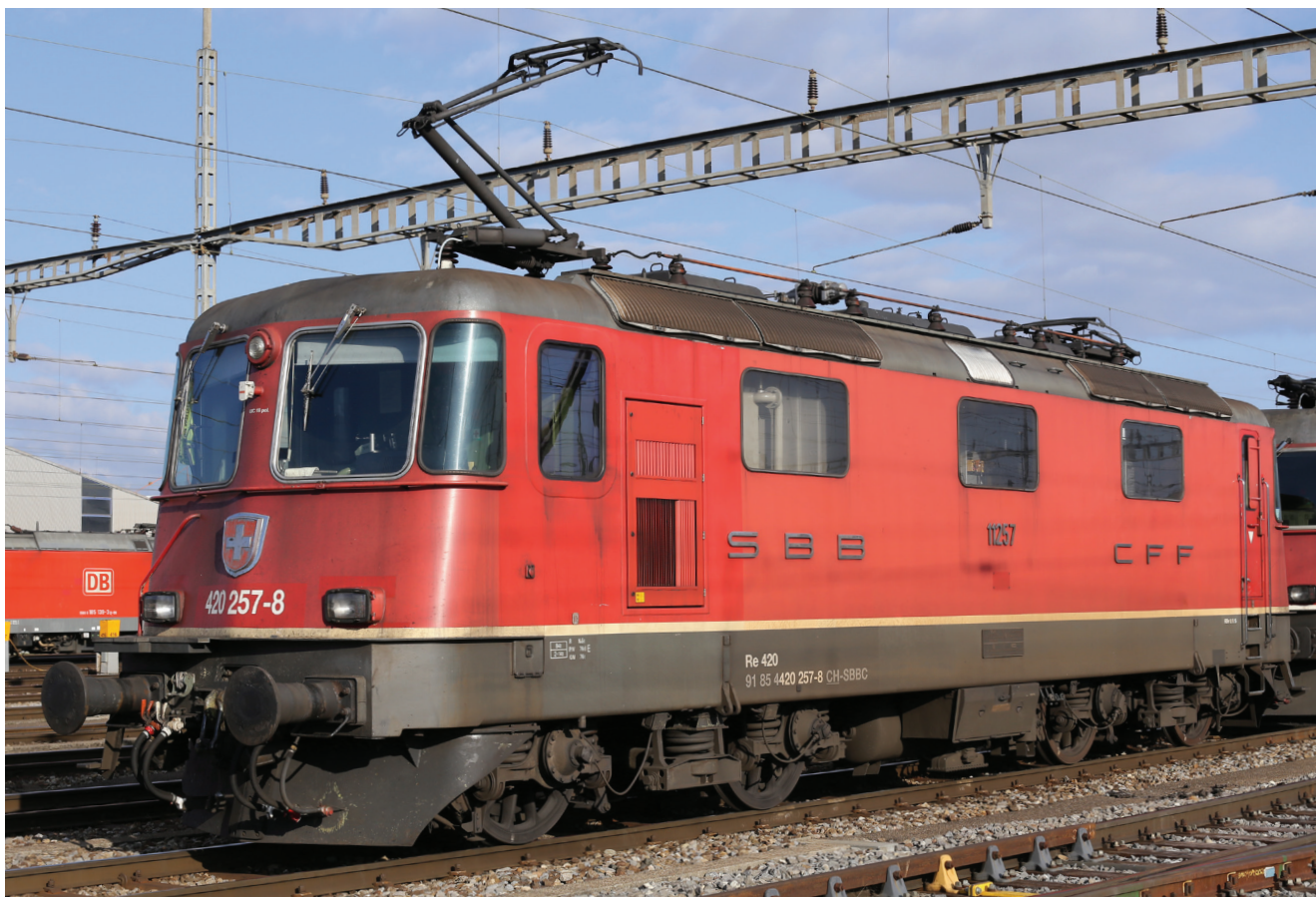
Die Re 420 91 85 4420 257-8 unterstützte am 27. März 2019 im Rangierbahnhof Limmattal eine Re 620. Um die Frontscheiben der hinteren Lok vor Beschädigungen durch am Stromabnehmerschleifstück entstandene Funken zu vermeiden, ist vorschriftsgemäss der vordere Stromabnehmer gehoben.
