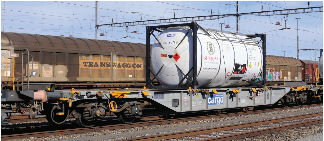
Am 12. April 2018 wurde im Rangierbahnhof Limmattal der mit einer Heizleitung ausgerüstete Sgnss 31 85 4552 111-0 angetroffen. Was der Grund für diese Nachrüstung war und ob noch weitere Sgnss umgebaut worden sind ist nicht bekannt.
