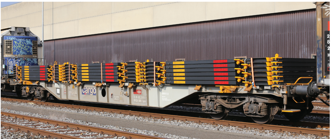
Mit 18 fabrikneuen Adapterplatten beladen war der Sgnss 31 85 4552 075-7 am 19. Oktober 2018 im Rangierbahnhof Limmattal abgestellt. Mit ihnen können sechs weitere Sgnss zu mit Fahrzeugen befahrbaren Flachwagen umgerüstet werden.
