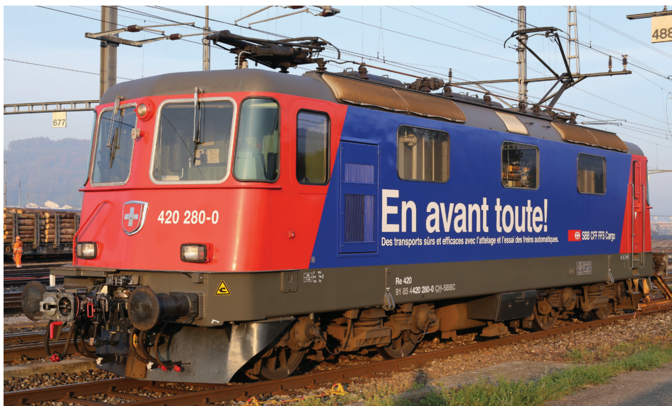
Die als erste im Sommer 2018 mit hochklappbaren, automatischen Kupplungen der Bauart Scharfenberg von der Voith Turbo GmbH & Co. KG, Salzgitter (D), offiziell auch als Hybridkupplung «UIC/Voith-CargoFlex» bezeichnet, ausgerüstete Re 420 91 85 4420 280-0 am Morgen des 17. Oktober 2018 im Rangierbahnhof Limmattal. Später wurde die Werbung für den sogenannten Automationspiloten noch mit den Logos der beteiligten Firmen Voith, PJM und VTG ergänzt.
