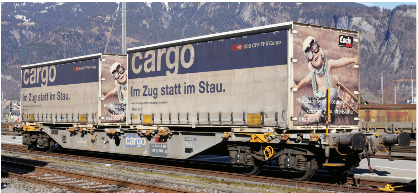
Der am 30. September 2003 durch die Ferriere Cattaneo SA, Giubiasco (FC), an SBB Cargo gelieferte Sgnss 31 85 4552 001-3 war am 18. Februar 2020 mit zwei Eschtec-Behältern beladen in Landquart abgestellt.
