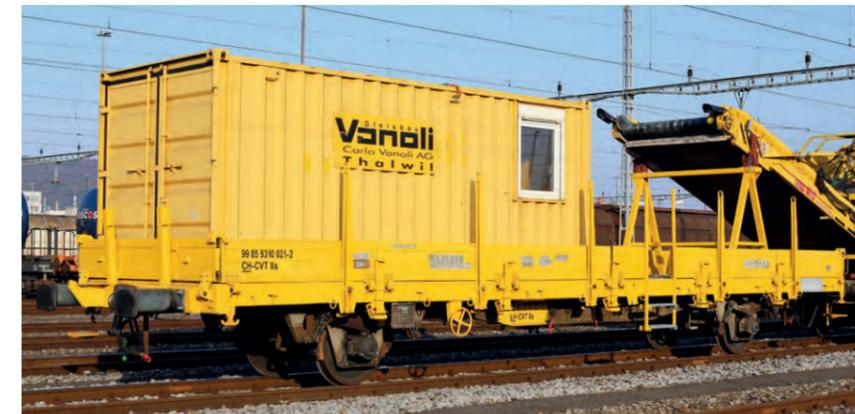
Der als Schutzwagen zu MFS verwendete Xs [Vs] 99 85 9310 021-2 am 13. März 2015 im Rangierbahnhof Limmattal. Die verlängerte Pufferbohle zeigt, dass der Wagen ursprünglich mit einer Bremserbühne ausgerüstet war. Die Länge über Puffer beträgt deshalb entgegen der Anschrift am Wagen 13,98 m und nicht 13,86 m.
