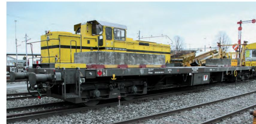
1995 konnte die Kirow Leipzig AG den SBB zwei Gleisbaukräne des Typs KRC 800 liefern. 2011 wurde einer der beiden, der XTmaas 80 85 95 89 001-9, samt dem zugehörigen, mit eigenem Antrieb ausgerüsteten Schutzwagen XTmas 80 85 98 89 010-7 ausrangiert. Letzteren übernahm 2012 die Carlo Vanoli AG und stellte ihn als VTmas 99 85 9310 020-4 in Dienst. Am 24. Januar 2015 konnte er als MFS-Schutzwagen hergerichtet in Samstagern fotografiert werden.
