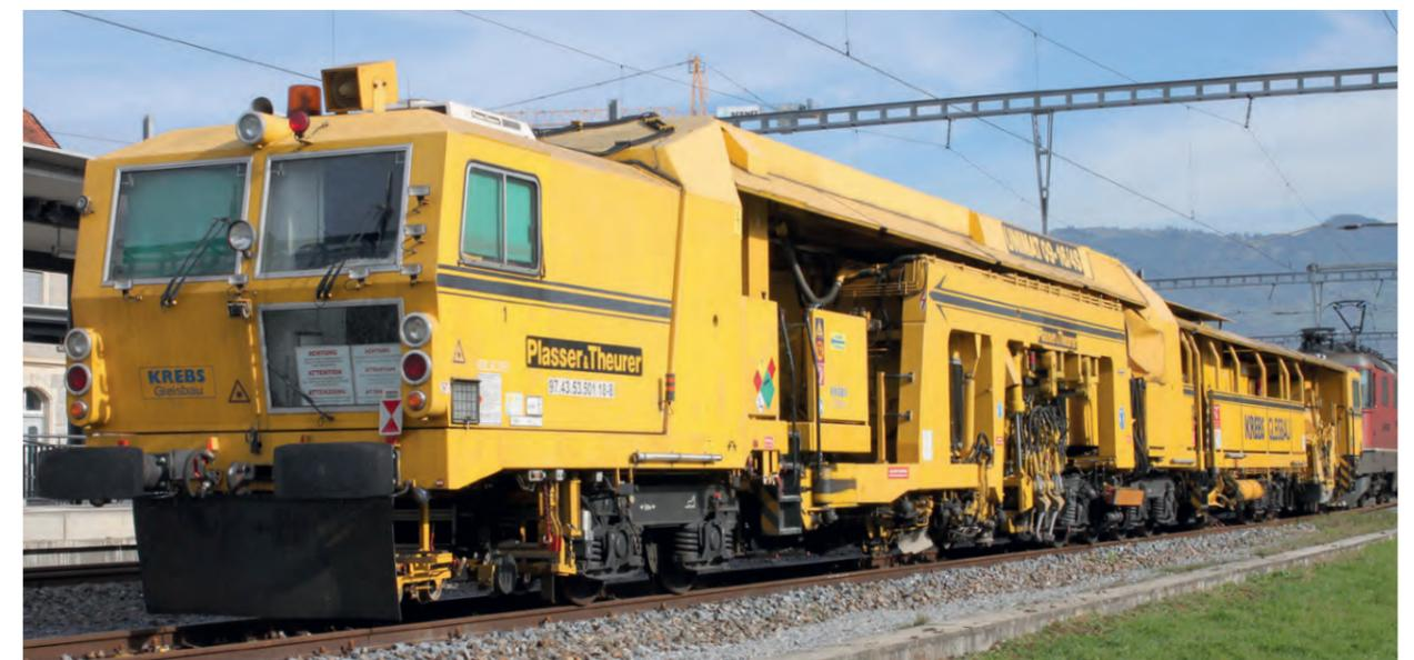
In Uznach war am 25. Oktober 2013 die SBB Cargo-Re 4/4<sup>II</sup> 11190 mit der Unimat 09-16/4S von Krebs Gleisbau zum nächsten Einsatzort Herisau unterwegs. Auffallend sind die überbreiten Pufferteller und die zahlreichen Arbeits- und Signalleuchten an der Stirnseite. Unter der Bedienerkabine ist das Richtmesssystem der Maschine angeordnet.
