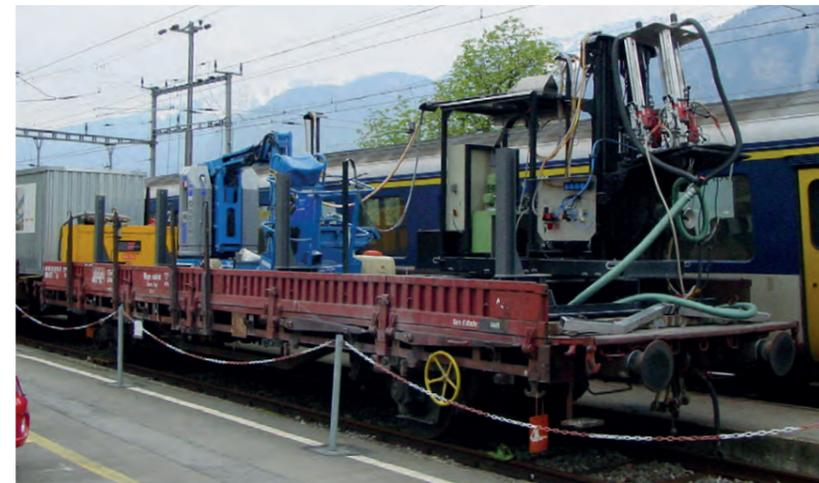
Der 1990 aus einem SNCF-Ks entstandene Vs 40 85 95 06 114-9 am 17. April 2004 in Mühlehorn. Beim Ladegut handelt es sich um eine Bohreinrichtung, mit welcher Montagelöcher für Tunnelsignale, Fahrleitungstragwerke, Funkkabelaufhängungen und ähnliche Anwendungen in Tunnelgewölbe gebohrt werden können. Ganz links auf dem Wagen die Dieselnotstromgruppe zur Energieversorgung, in der Mitte eine Teleskoparbeitsbühne.
