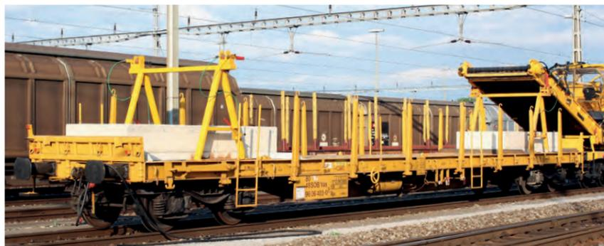
Am 13. Juni 2008 erhöhten zusätzliche Betongewichte die Tara des Vas/Rgs 80 48 98 06 403-0 auf 40 t. Zudem standen neu an beiden Wagenenden Stützböcke für die MFS-Übergabebänder zur Verfügung. Das Bild des 1981 durch die bulgarische Waggon-fabrik Burgas gebauten Wagens entstand im Rangierbahnhof Limmattal.
