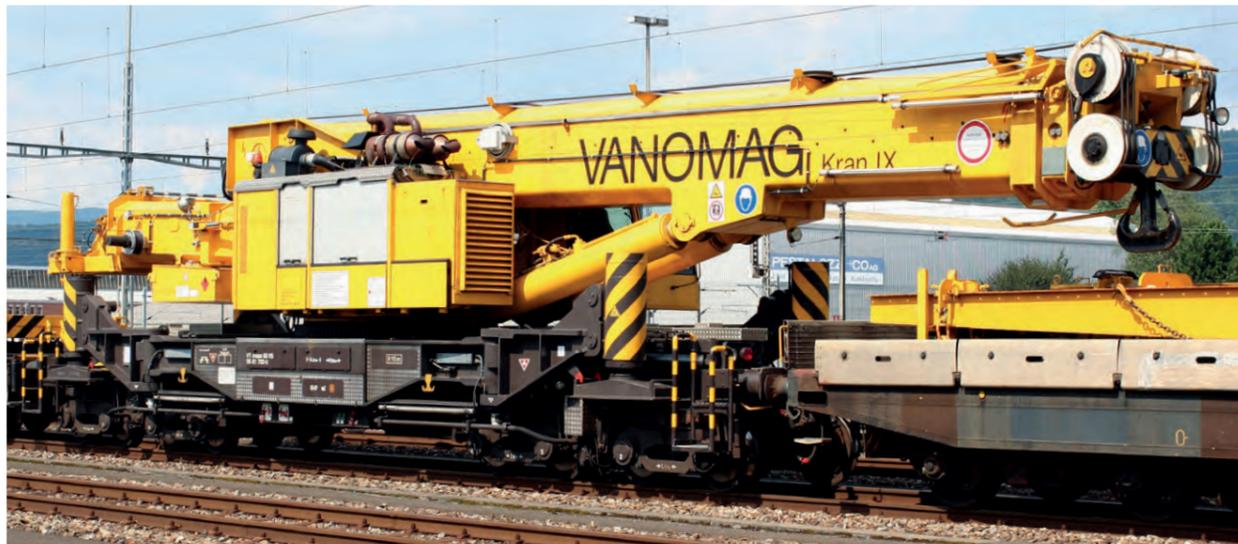
Der trotz der möglichen Höchstgeschwindigkeit von 120 km/h als VTmaas bezeichnete [VTmaas] 80 85 95 81 702-0 am 23. August 2005 im Rangierbahnhof Limmattal. Seine Eigenfahrgeschwindigkeit liegt bei 25 km/h.
