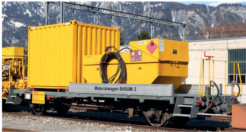
Komplett umgestaltet war der P 10152 am 28. März 2008 in Landquart zu sehen. Neu war er als Materialwagen der Nivellier-Richt-Stopfmaschine B 40 UM-3 zugeteilt. Neben niedrigen Aluminiumbordwänden hatte der Umbau auch eine Übergangsbühne am zweiten Wagenende gebracht. Anfang 2011 erfolgte der Abbruch dieses Wagens.
