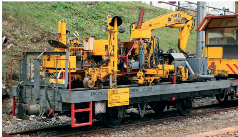
In Pontresina war der P 10153 am 26. September 2009 abgestellt. Die Bezeichnung «Vk 10153» ist nur noch teilweise vorhanden, für die Anschriften war in der Zwischenzeit eine zusätzliche Tafel montiert worden. Der Wagen diente hier dem Transport eines Schienenhebergeräts (links) und eines Schienenumsetzgeräts (Mitte). Der stirnseitige Hiab-Kran erleichtert deren Auf- und Ablad.
