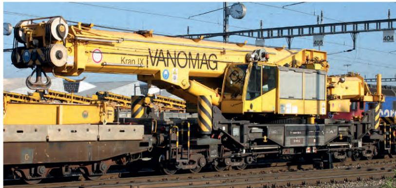
Ebenfalls noch mit seiner ursprünglichen Bezeichnung VTmaas[s] 80 85 95 81 702-0 war der Vanomag-Kran IX am 24. Oktober 2011 im Rangierbahnhof Limmattal unterwegs. Parallel zum für Gleisbauarbeiten prädestinierten Kran VIII beschaffte Vanomag 2001 diesen für Gleisbauarbeiten und auch Brückenmontagen ausgelegten Kran des Typs GS 130.10 TS bei der Mannesmann Dematic Gottwald AG in Düsseldorf (D).
