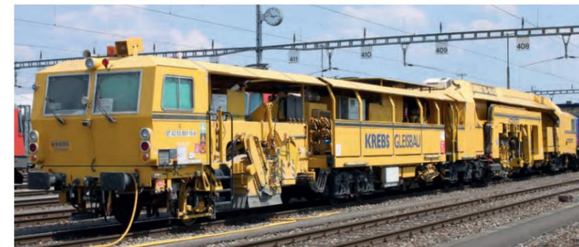
Die gegenüberliegende Fahrzeugseite der Unimat 09-16/4S am 15. Juli 2013 im Rangierbahnhof Limmattal. Die 42,94 m lange Gleis- und Weichenstopfmaschine verfügt über insgesamt neun Achsen, wobei neben der links im Bild erkennbaren Einzelachse vier Drehgestelle vorhanden sind.
