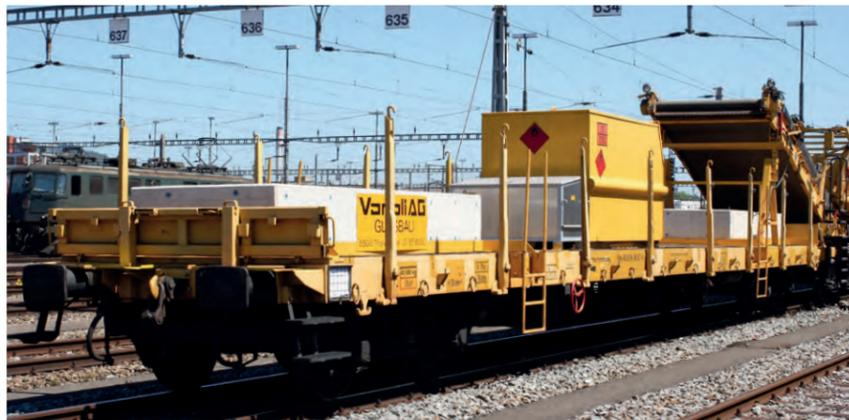
Ohne Containerlast, dafür mit zwei das Eigengewicht auf 40 t erhöhenden Betonklötzen beladen konnte der Vas 80 48 98 06 401-4 am 29. Juli 2009 erneut im Rangierbahnhof Limmattal fotografiert werden. Der Dieselöltank ist neu in der Mitte positioniert. Eine zusätzliche Material- oder Werkzeugkiste vervollständigt die Ausrüstung. Wenig später wechselte der Wagen in den Vanomag-Bestand, wo er als Material- und Gegenlastwagen zum Kran XI eingesetzt wurde.
